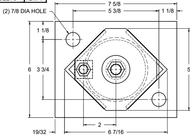
**TYPE AMSR-1E-SB SEISMICALLY RESTRAINED SPRING VIBRATION ISOLATORS WITH SHIPPING BLOCK**
